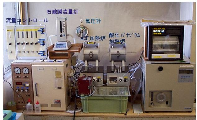
写真1 固定床流動反応装置
