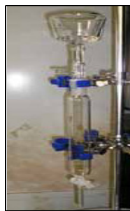
図 1 ガラス製ろ過、振とう、液-液分配装置
