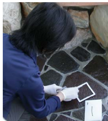
図6 10 × 10 cm の枠を用いて、ATP 拭き取り試験をおこなっている様子。 検査時間は全体として、数分間である。
