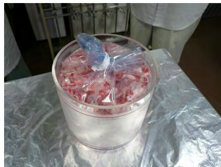
マリネリ測定容器に詰めた牛肉試料
