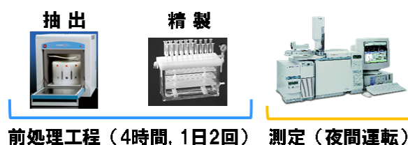
図3 GC-MSを測定系とした迅速スクリーニング
