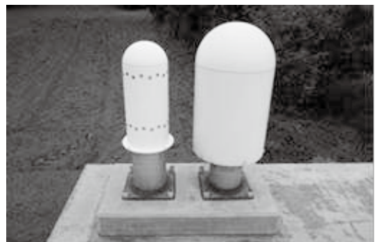
写真 2 モニタリングポスト 低線量計(左)と高線量計(右)
