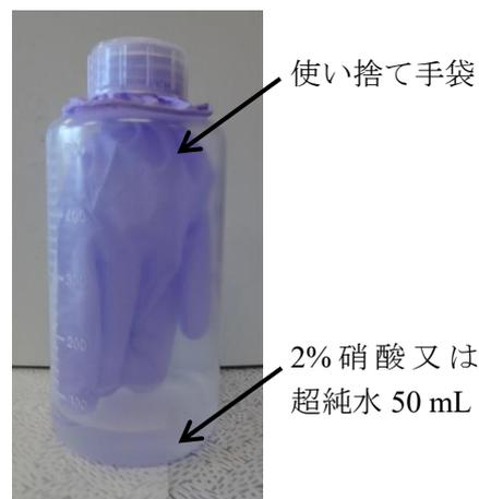
図 1 金属溶出試験の様子
