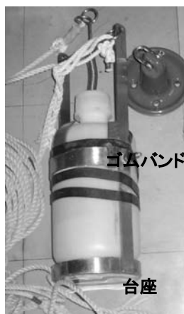
図2 ハイロート採水器
