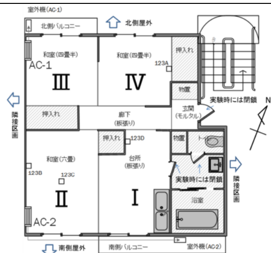
図1 実験区画の間取り及び測定機器等設置箇所
